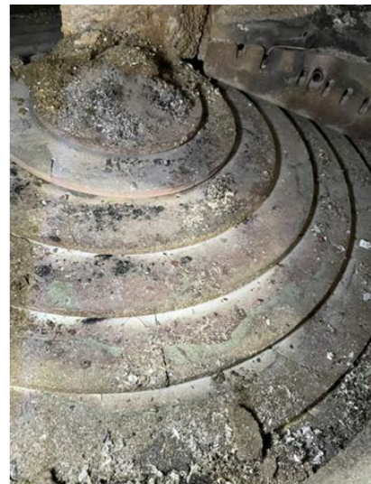
写真3. アルミナ蒸着処理後一週間燃焼したボイラーリングの状態
