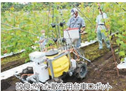
改良された散布用台車ロボット
